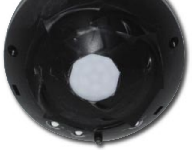
An der Decke montierter Bewegungsmelder. Quelle OFFIS.
