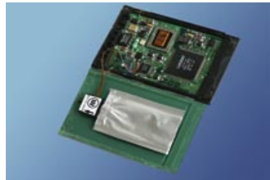
Prototyp einer PCMCIA-Karte mit integriertem Flüssigkeitsreservoir und Fördereinheit. Quelle: Bartels Mikrotechnik GmbH.
